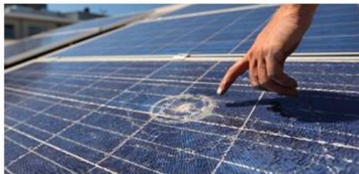
Gambar 1. Kerusakan Panel Surya Akibat Hujan Es
